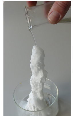
Etats métastables. Acétate de sodium, Chambre à brouillard de Wilson
